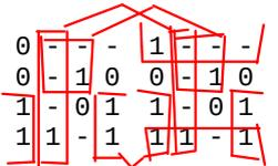
$$D_1 = IN\overline{Q_0} + \overline{Q_3}Q_2 + Q_2\overline{Q_1} + \overline{Q_2}Q_1$$
