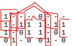
$$D_0 = \overline{IN}Q_3\overline{Q_1} + \overline{Q_3}Q_2 + Q_2\overline{Q_1} + \overline{Q_2}Q_0$$
