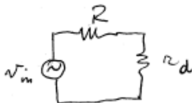
Figura 2.2: Circuiti per piccoli segnali in cui il diodo è sostituito con la sua resistenza differenziale.
