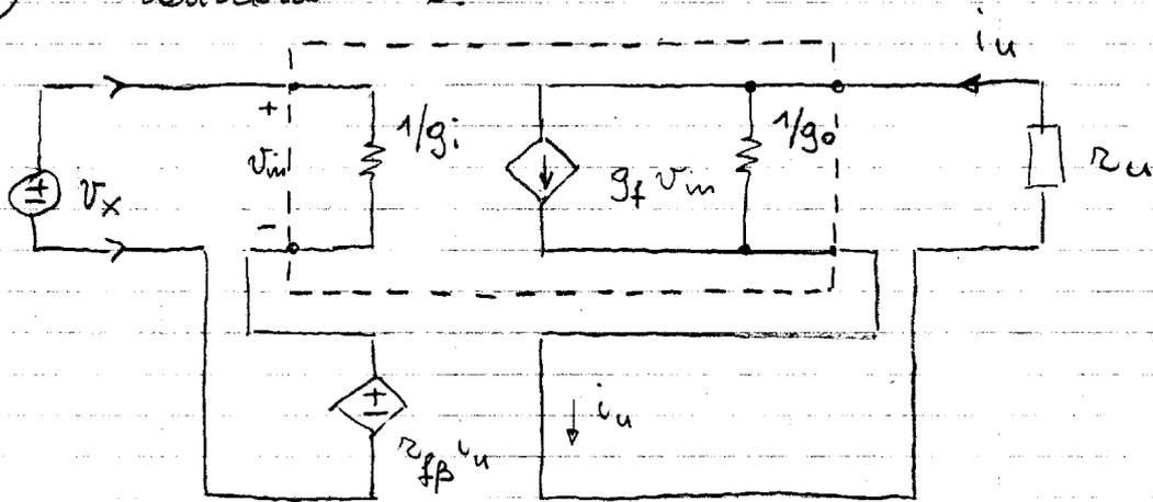
Reazione negativa di corrente (alta impedenza di uscita) serie (alta impedenza di ingresso)
