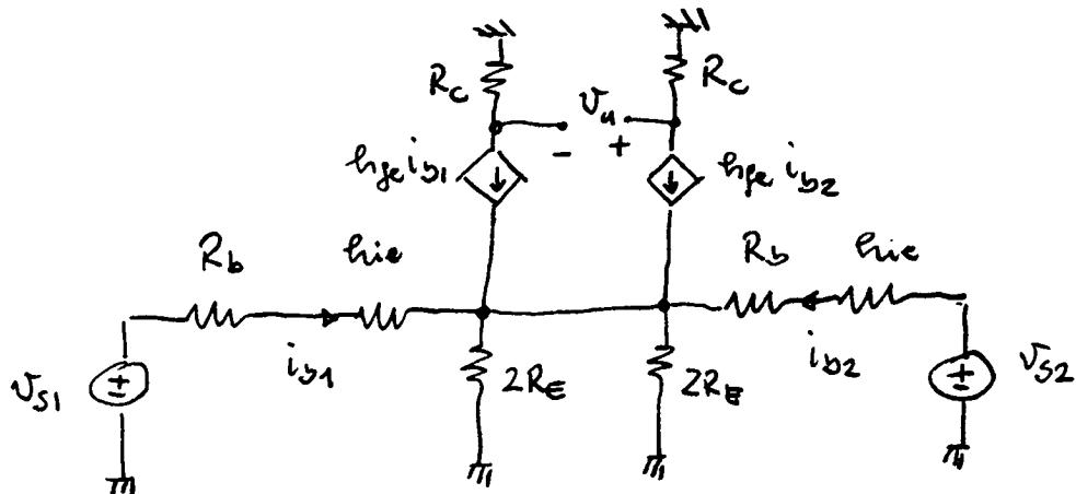
siccome viene chiesto  $A_c$  (modo comune) e  $A_d$  (modo differenza) conviene scomporre  $V_{S1}$  e  $V_{S2}$  nelle due componenti
