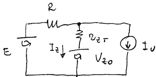
$$V_{zo} = V_{zT} - r_{zT} \cdot I_{zT} = 8.8 \text{ V}$$
