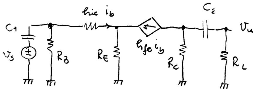
Si tratta di un amplificatore a "doppio carico", con uscita sul collettore.
