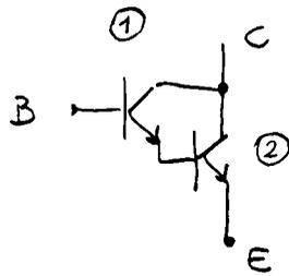
$$V_{BE0u}^* = 2V_{BE0u} = 1,4 \text{ V}$$
