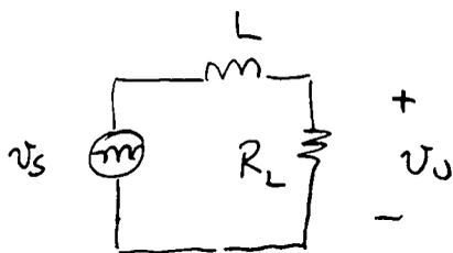
$$v_s = V_m \sqrt{2} |\sin 2\pi f t| \quad \text{periodica con frequenza } 100\text{Hz}$$
