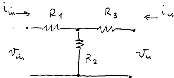
$$\begin{cases} v_{in} = R_1 i_{in} + R_2 (i_{in} + i_u) = (R_1 + R_2) i_{in} + R_2 i_u \\ v_u = R_3 i_u + R_2 (i_{in} + i_u) = R_2 i_{in} + (R_3 + R_2) i_u \end{cases}$$
