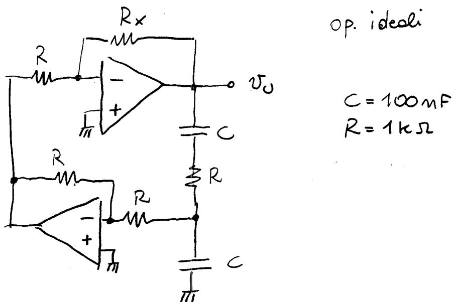
$$R_x = 5R, e^{-V_o/V_0} \quad \text{con } V_o \text{ ampiezza uscita}$$
