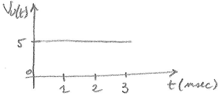
Abbiamo che  $\bar{V}_0 = \frac{1}{T} \int_0^T V_0(t) dt = 5V$
