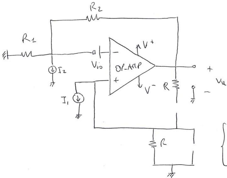
$$\begin{cases} I_1 = I_B + \frac{I_{io}}{2} \\ I_2 = I_B - \frac{I_{io}}{2} \end{cases}$$
