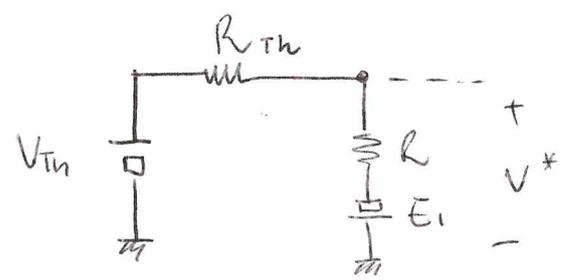
$V^* = V_{Th} \cdot \frac{R}{R+R_{Th}} - E_1 \cdot \frac{R_{Th}}{R+R_{Th}}$
