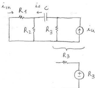
$$i_c = \frac{R_3 i_u}{R_3 + \frac{1}{C} + R_1 // R_2}$$
