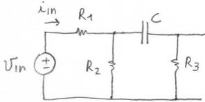
$$i_{in} = \frac{V_{in}}{R_1 + R_2 // \left( \frac{1}{C} + R_3 \right)} \Rightarrow$$
