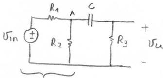
$$V_u = V_{in} \frac{R_2}{R_1 + R_2} \frac{R_3}{R_1 // R_2 + \frac{1}{C} + R_3} \Rightarrow$$
