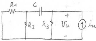
$$V_u = i_u \left[ R_3 // \left( \frac{1}{C} + R_1 // R_2 \right) \right] \Rightarrow$$
