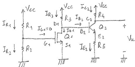
$$R1 \text{ e } R2 \text{ sono attraversate dalla stessa corrente} \Rightarrow V_{G1} = V_{cc} \frac{R2}{R1 + R2} = 2 \text{ V}$$
