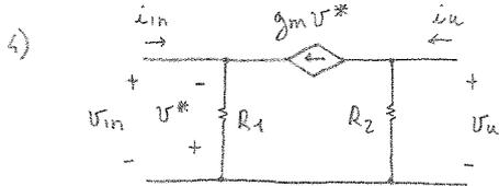
$$\begin{cases} i_u = h_f i_{in} + h_o v_u \\ v_{in} = h_i i_{in} + h_r v_u \end{cases}$$
