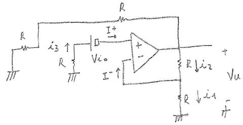
per il c.c.v.  $i_3 = I^+ = 0 \Rightarrow V^+ = -V_{io} = V^- \Rightarrow i_1 = \frac{V^-}{R} = \frac{-V_{io}}{R} = i_2 \Rightarrow V_u = Ri_1 + Ri_2 = 2R \cdot \left(\frac{-V_{io}}{R}\right) = -2V_{io}$
