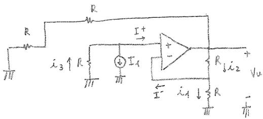
per il c.c.v.  $I^+ = 0 \Rightarrow i_3 = I_1 \Rightarrow V^+ = -Ri_3 = -RI_1 = V^- \Rightarrow i_1 = \frac{V^-}{R} = \frac{-RI_1}{R} = i_2 \Rightarrow V_u = Ri_1 + Ri_2 = 2R \cdot (-I_1) = -2RI_1$
