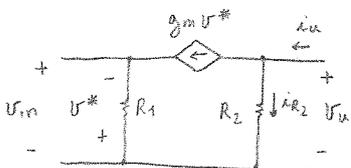
essendo l'ingresso lasciato aperto,  $R_1$  è attraversata dalla corrente  $g_m v^* \Rightarrow v^* = -R_1 g_m v^* \Rightarrow v^* (1 + R_1 g_m) = 0 \Rightarrow v^* = 0 \Rightarrow g_m v^* = 0$
