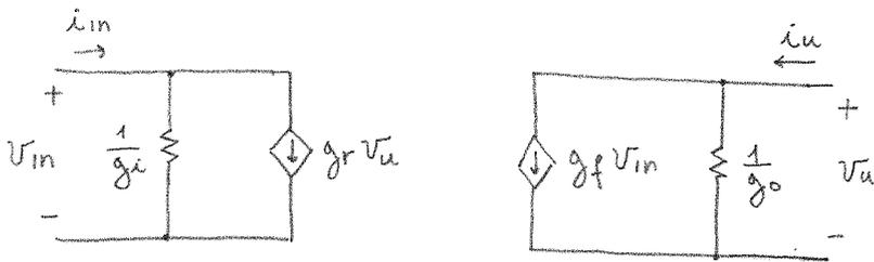
$$\begin{cases} V_u = f_f V_{in} + f_o i_u \\ i_{in} = f_i V_{in} + f_r i_u \end{cases}$$
