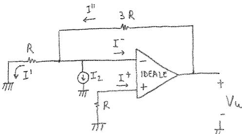
essendo  $I^+ = 0$  (per il ccv) su  $R$  non scorre corrente  $\rightarrow V^+ = 0 = V^- \rightarrow$  la differenza di potenziale ai capi della  $R$  più a sinistra è nulla  $\rightarrow I^1 = 0 \rightarrow$  essendo anche  $I^- = 0$  (per il ccv),  $I'' = I^1 + I_2 + I^- = I_2 \rightarrow V_u = V^- + 3RI_2 = 3RI_2$
