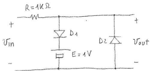
per  $V_{in} \leq 0$   $D_2$  conduce e  $D_1$  è interdetto  $\rightarrow V_{out} = 0$
