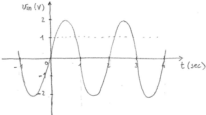
allora la  $V_{out}(t)$  sarà pari a 0 per  $V_{in}(t) \leq 0$ , sarà pari a  $V_{in}(t)$  per  $0 \leq V_{in}(t) \leq 1$  e sarà pari a 1 per  $V_{in}(t) \geq 1$ :
