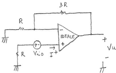
essendo  $I^+ = 0$  (per il ccv) non c'è caduta su  $R$ , per cui  $V^+ = -V_{io} = V^- \rightarrow V_u = (-V_{io}) \left(1 + \frac{3R}{R}\right) = -4V_{io}$
