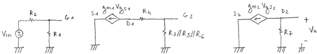
$$V_u = -g_{m2} V_{GS2} R_7$$
