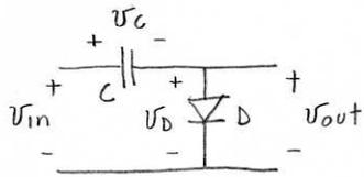
poi  $V_{in}$  cresce, istantaneamente  $V_C$  non cambia, quindi per  $t=0+$  ci ritroviamo una  $V_D$  che tende a crescere e a diventare  $> 0$ , quindi il diodo conduce; se il diodo conduce (assumiamo il diodo ideale)  $V_D = V_{out} = 0$ ;
