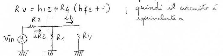
quindi  $i_{R_2} = \frac{V_{in}}{R_2 + R_1 // R_V}$  ; dopodiché  $i_b = i_{R_2} \frac{R_1}{R_1 + R_V}$  (partitore di corrente) ;
