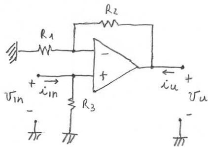
$$\begin{cases} V_u = f_f V_{in} + f_o i_u \\ i_{in} = f_i V_{in} + f_r i_u \end{cases}$$
