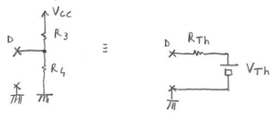
con  $R_{Th}$  (resistenza vista tra i due terminali indicati con "x" con  $V_{cc}$  disattivato) =  $R_3 // R_4 = 1500 \Omega$
