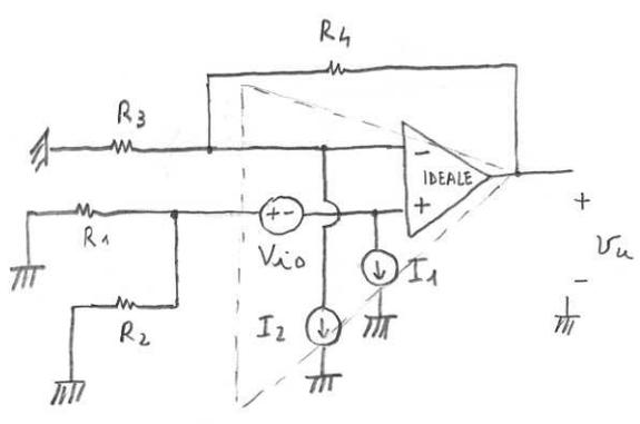
do po di che trovo l'effetto sulla  $v_u$  dei generatori di sbilanciamento applicando il principio di sovrapposizione degli effetti (e il c.c.v. per l'amplificatore operazionale ideale):
