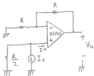
essendo  $I^+ = 0$  (per il ccv) da  $\frac{R}{2}$  passa  $I_1$ , per cui  $V^+ = -\frac{R}{2} I_1$   $\rightarrow V_u = \left(-\frac{R}{2} I_1\right) \left(1 + \frac{R}{R}\right) = -R I_1$  amplificazione dell'amplificatore non invertente
