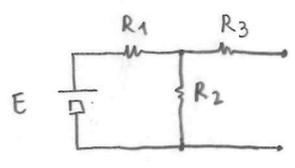
la tensione di Thevenin (tensione a vuoto) è pari a  $\frac{E R_2}{R_1 + R_2}$ ;
