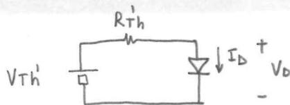
l'altra relazione tra  $I_D$  e  $V_D$  da mettere a sistema con la caratteristica corrente-tensione del diodo è quella che si ottiene facendo l'equilibrio delle tensioni alla maglia cioè
