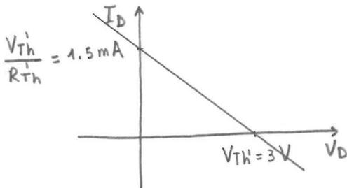
l'intersezione di questa retta (retta di carico) con la caratteristica corrente-tensione del diodo dà il punto di lavoro del diodo, la cui ascissa e ordinata rappresentano rispettivamente la tensione e la corrente a riposo nel diodo  $D$
