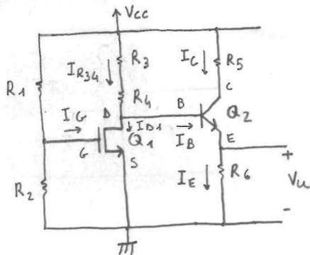
$$V_G = V_{CC} \frac{R_2}{R_1 + R_2} = 2V \quad (\text{dato che } I_G = 0)$$
