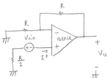
essendo  $I^+ = 0$  (per il ccv) non c'è caduta su  $\frac{R}{2}$ , per cui  $V^+ = -V_{io} = V^-$  per il c.c.v.  $\rightarrow V_u = (-V_{io}) \left(1 + \frac{R}{R}\right) = -2V_{io}$  amplificazione dell'amplificatore non invertente
