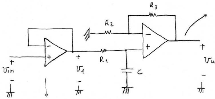
qui a causa della reazione di tensione la resistenza di uscita è già zero nulla (esattamente nulla se l'A.O. già di per sé ha  $R_{out} = 0$ ), quindi non c'è bisogno di un buffer per rendere la  $R_{out} = 0$  e quindi l'uscita indipendente dalla resistenza di carico
