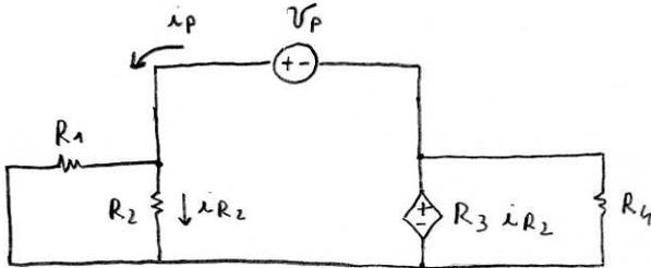
$$V_P = \underbrace{R_2 i_{R_2}}_{\text{caduta sulla } R_2} - \underbrace{R_3 i_{R_2}}_{\text{tensione ai capi del generatore } R_3 i_{R_2}} = (R_2 - R_3) i_{R_2}$$
