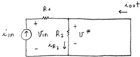
per cui  $v_{in} = R_1 i_{in} \rightarrow h_i = \frac{v_{in}}{i_{in}} = R_1$
