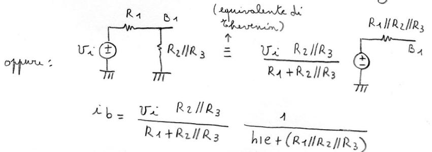
$A_v(\infty) = -\frac{R_9 g_m}{1 + R_9 g_m} h_{fe} (R_4 // R_7) \frac{R_2 // R_3}{h_{ie} + R_2 // R_3} \frac{1}{R_1 + (R_2 // R_3 // h_{ie})} = -0.3473$  (negativo, come è giusto che sia dato che si tratta di uno stadio a emettitore comune, invertente, e di uno stadio a drain comune, non invertente, in cascata)
