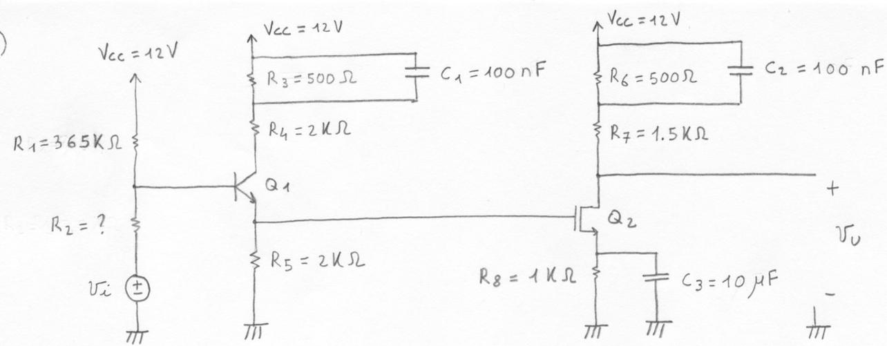
per  $Q_1$ :  $h_{FE} = 199$  ; per  $Q_2$ :  $V_T = 1V$  ,  $\frac{1}{2} \mu_n C_{ox} \frac{W}{L} = 2 \frac{mA}{V}$
