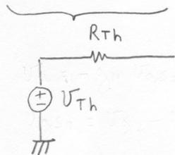
con  $V_{Th} = V_i \frac{R_1}{R_1 + R_2}$
