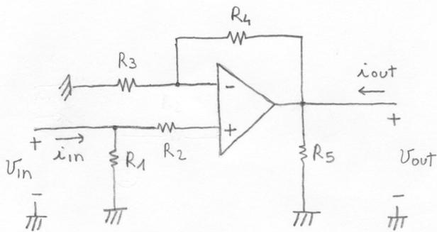
$$\begin{cases} V_{out} = r_f i_{in} + r_o i_{out} \\ V_{in} = r_i i_{in} + r_r i_{out} \end{cases}$$
