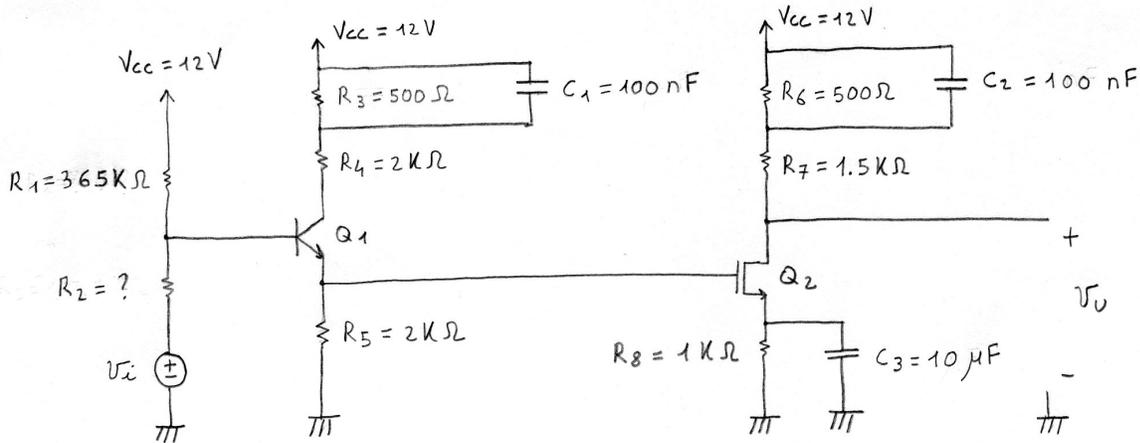
per  $Q_1$ :  $h_{FE} = 100$  ; per  $Q_2$ :  $V_T = 1\text{ V}$  ,  $\frac{1}{2} \mu_n C_{ox} \frac{W}{L} = 2 \frac{\text{mA}}{\text{V}}$
