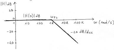
el circuito si comporto da filtro para-basso del 1º ordine con limite superiore di banda UP2 e guadagno en banda parante H(0)=1
