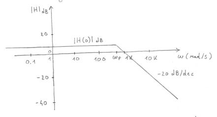
el circuito si comporto do filtroporso-losso obl $1^\circ$  ordine con limite reperiore di bando  $\omega_p$  e guadagno in bando porrante H(o)=2
