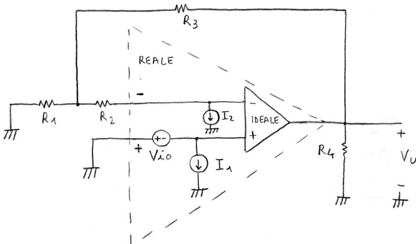
Adesso calcoliamo l'effetto sull'uscita dei generatori di offset usando la sovrapposizione degli effetti e sfruttando il metodo del cortocircuito virtuale per l'amplificatore operazionale ideale:
