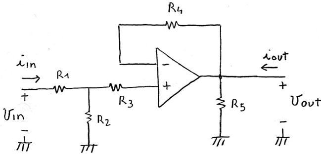
$$\begin{cases} U_{out} = r_f i_{in} + r_o i_{out} \\ U_{in} = r_i i_{in} + r_r i_{out} \end{cases}$$
