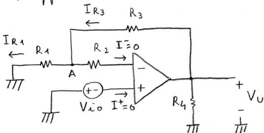
per il c.c.v.  $V^- = V^+ = -V_{io}$  ;
