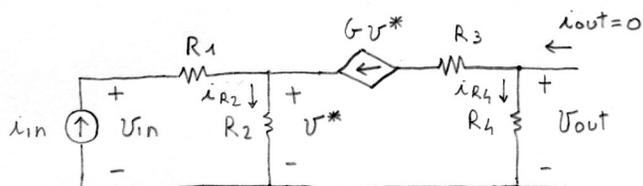
esempio  $i_{out}=0$ ,  $i_{R4} = -G U^*$   $\rightarrow U_{out} = R_4 i_{R4} = -R_4 G U^*$
