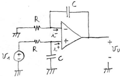
$$\text{per il c.c.v. } i^+ = 0 \rightarrow v^+ = \frac{1}{CS} v_1 = \frac{v_1}{1+RCS}$$
