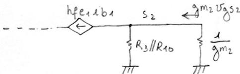
$$U_{s2} = -h_{fe1} i_{b1} \left( R_3 // R_{10} // \frac{1}{g_{m2}} \right)$$
