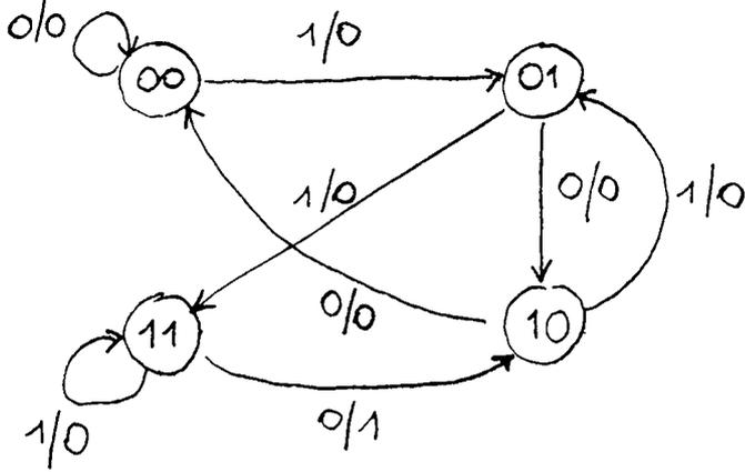
Si tratta di un riconoscitore di sequenze che riconosce 110
