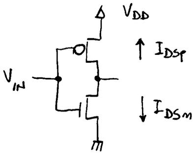
la condizione di massima corrente si ha con i due transistori in saturazione (nell'ipotesi che uno dei due sia in zona triodo, si potrebbe aumentare la corrente modificando la  $V_{IN}$  in modo da aumentare la  $|V_{GS}|$  dell'altro).
