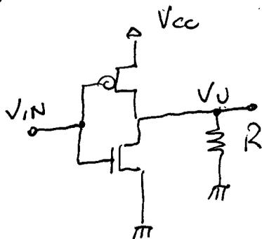
Nel caso  $V_{IN} = V_{cc}$ , il pMOS è interdetto e  $V_O = 0$
