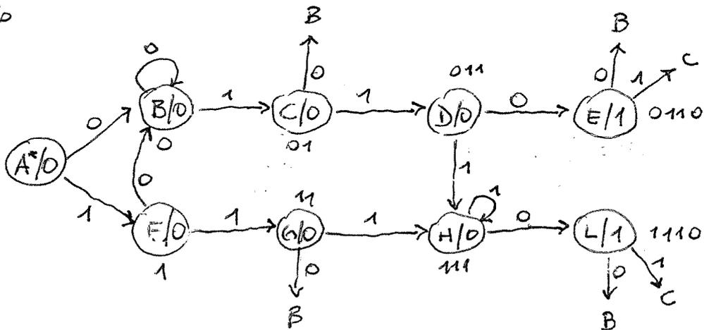
Osservazioni: in A, F, G non arriva alcuna freccia - possono essere eliminati con l'avvertenza di inizializzare la macchina con 2 zeri (va sempre in B) e scartare le uscite prima di ulteriori 4 cicli di clock (si evita il riconoscimento spurio di 110)
